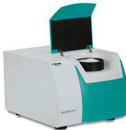
Рис. 2: Анализатор NIRS DS2500 использованный для получения спектров 236 проб при трехкратном измерении во всем диапазоне 400 – 2500 нм.
