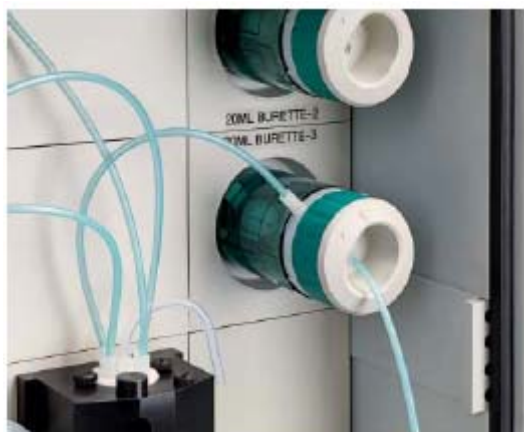
Прецизионные бюретки, дозирующие подачу титрантов или реагентов.
